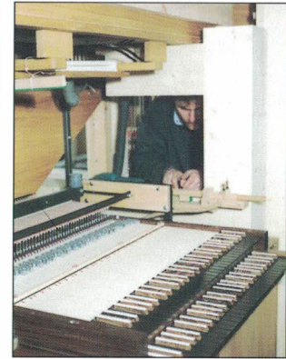
Spieltraktur mit Koppeln im Inneren des Spielschrankes (unten)
